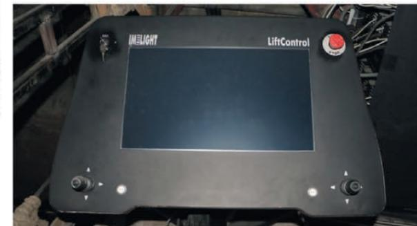
программировать, синхронизировать и задавать разную скорость для каждой точки подъема. Она способна работать как с тросовыми лебедками, так и с цельными лебедками стандартов BGV-C1 и BGV-D8+ после внесения небольших изменений в конструктив лебедки.
