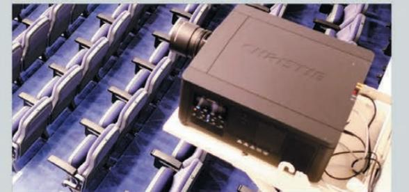
Проекция на большой экран осуществляется с помощью широкоформатного проектора Christie HD10K-M, оснащенного входным интерфейсом HD-SDI.
