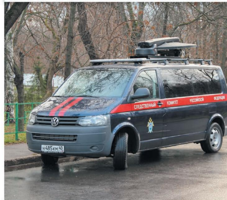
Станция предназначена для обеспечения трансляций цифровых ТВ-сигналов через геостационарные спутники связи в Ku-диапазоне.
