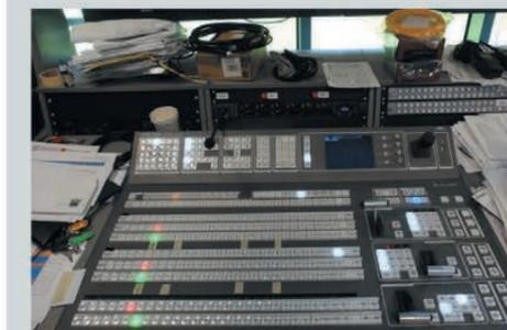
Видеомикшер Gumatex GVM-2425 позволяет формировать две программы с резервированием ключевых элементов тракта.
