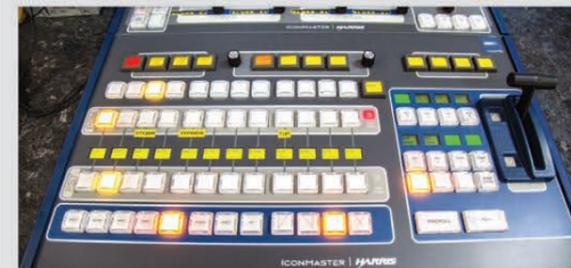
Эфирный видеомикшер Imagine Communications Icon Master помимо вещания обеспечивает графическое оформление программ.
