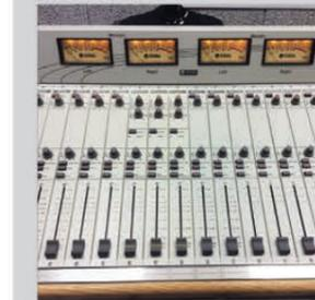
Резервный модульный эфирный микшер Axel Oxygen 4.
