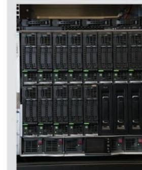
Каждое блейд-шасси имеет два модуля HPE 10GbE для подключения виртуальной машины Versio к коммутаторам Arista для формирования и принятия потоков SMPTE 2022-6.
