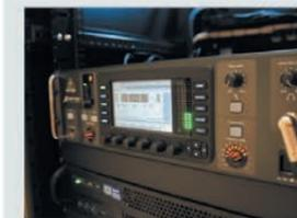
Аудиотракт реализован на базе цифрового микшера Behringer X32.
