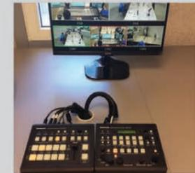
Система видеосъемки построена на базе камер и видеомикшеров Panasonic.
