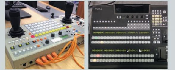
Многофункциональный пульт Panasonic AW-RP655L обеспечивает ввод в память и вызов из нее до 50 положений поворотного устройства.
