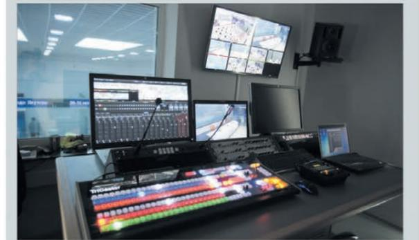
Бесперебойное потоковое интернет-вещание проводимых мероприятий в формате высокой четкости обеспечивает производственная студия NewTek TriCaster.
