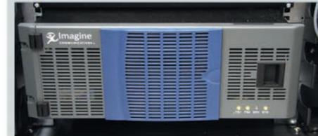
Система Image Communications ADC позволяет автоматизировать работу большого количества устройств комплекса, основываясь на подготовленном расписании для каждой зоны вещания.
