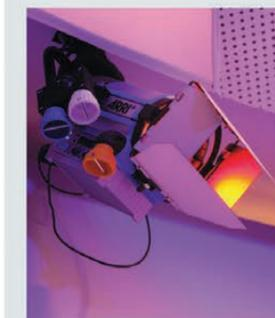
Приборы ARRI, расположенные на потолке, являются источником заполняющего и контрового света.
