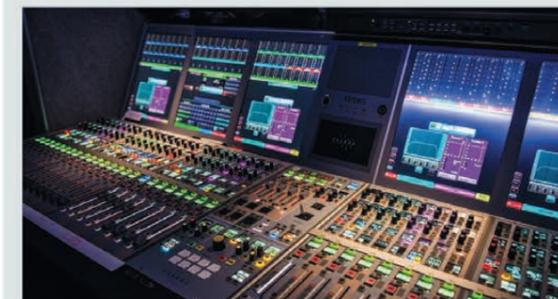
Эфирный аудиомикшер Calrec Artemis с возможностью резервирования. Все кнопки панели имеют светодиодную подсветку, и каждой из них можно присвоить свой цвет в зависимости от назначенной функции.
