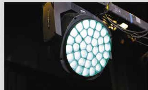
Полноповоротные прожекторы Clay Paky обеспечивают цветные wash-эффекты при раскрытии луча от 6° до 70°, а при сокращении угла до 4° размытый свет превращается в узкий параллельный луч.
