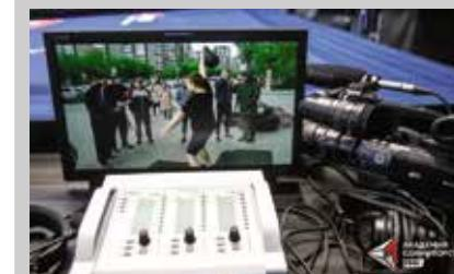
Комментаторский блок AEQ Olympia подключен к звуковому тракту посредством протокола Dante.
