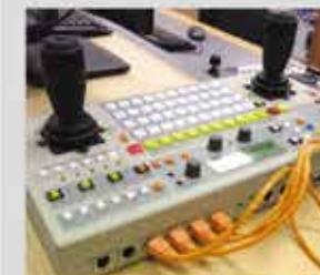
Многофункциональный пульт Panasonic AW-RP655L обеспечивает ввод в память и вызов из нее до 50 положений поворотного устройства.
