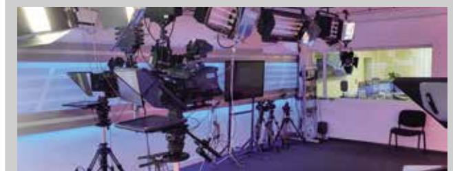
Для обеспечения видеосъемок в телестудии установлен комплект LED-светильников с наружными радиаторами, ручным и дистанционным DMX-управлением.
