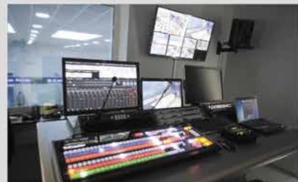
Бесперебойное потоковое интернет-вещание проводимых мероприятий в формате высокой четкости обеспечивает производственная студия NewTek TriCaster.
