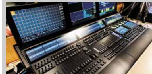
Система управления постановочным освещением состоит из основного пульта управления светом grandMA3 и дополнительного блока для увеличения выходных линий DMX 512.
