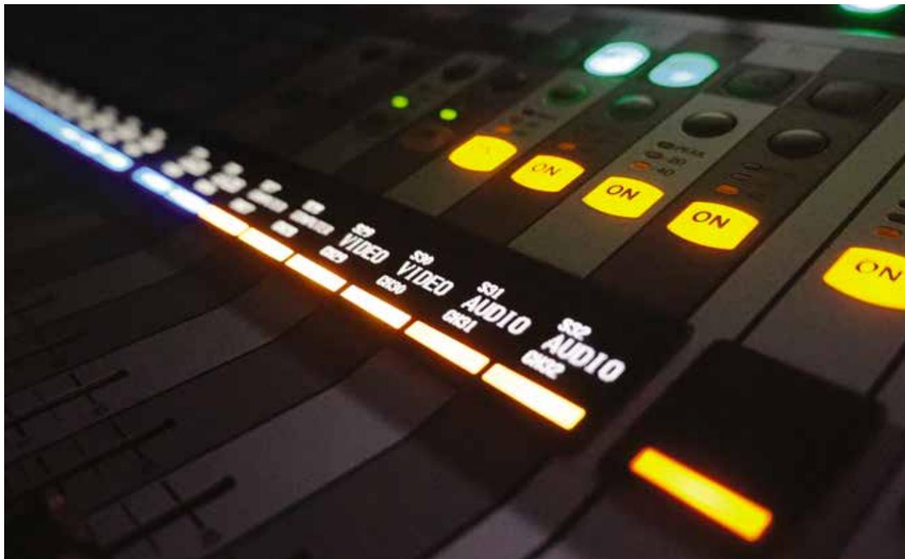
ИНТЕРЕСНОЙ ОСОБЕННОСТЬЮ ЗВУКОВОГО ТРАКТА ЯВЛЯЕТСЯ РАБОТА В ПОЛНОСТЬЮ ЦИФРОВОМ РЕЖИМЕ, ПО ПРОТОКОЛУ DANTE – СИГНАЛ ПРЕОБРАЗУЕТСЯ В АНАЛОГОВЫЙ ТОЛЬКО ОДИН РАЗ, В УСИЛИТЕЛЕ МОЩНОСТИ
