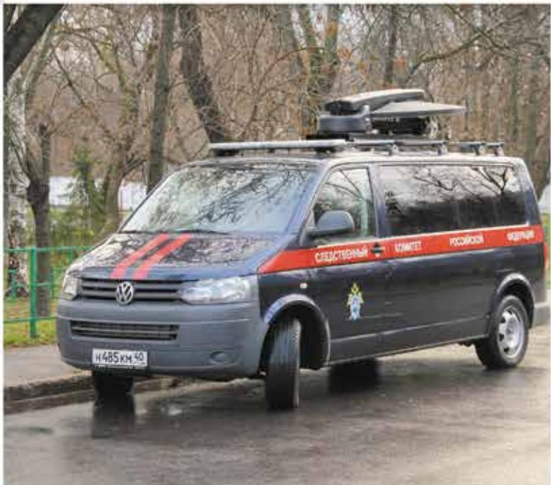
Станция предназначена для обеспечения трансляций цифровых ТВ-сигналов через геостационарные спутники связи в Ки-диапазоне.
