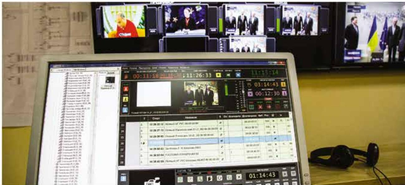
**АРХИТЕКТУРА ПОСТРОЕНИЯ КОМПЛЕКСА ПРЕДУСМАТРИВАЕТ ВОЗМОЖНОСТЬ ДОСТУПА К ОПЕРАТИВНОМУ И ДОЛГОВРЕМЕННОМУ ХРАНИЛИЩАМ ВИДЕОМАТЕРИАЛОВ СО ВСЕХ РАБОЧИХ СТАНЦИЙ И СЕРВЕРОВ ACK**
