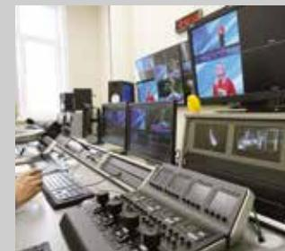
Цветоустановка и управление диафрагмами камер осуществляется с рабочего места инженера в аппаратной, оснащённого ATEM Camera Control, опорным монитором Oris и векторскопом.
