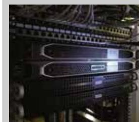
Lawo V\_matrix предлагает программно-определенную платформу для работы с IP-потоками. Модули C100 дают возможность инкапсуляции / деинкапсуляции сигналов IP и SDI, обработку видео или полизканный мониторинг в зависимости от выбранного приложения. А приложение vm\_udx обеспечивает преобразование форматов SD, HD и 4K с HDR.
