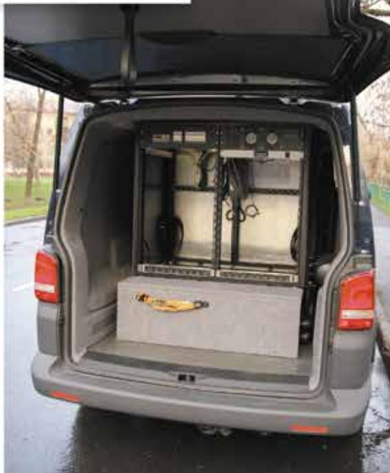
Автомобиль состоит из трех отсеков: водительского, технологического и транспортного. В технологическом отсеке расположены стойки для размещения оборудования. Имеется надежная защита рабочего отсена от несанкционированного прослушивания. Для коммутации внешних линий предусмотрен лючок по левому борту. Автомобиль оснащен кондиционером технологического
