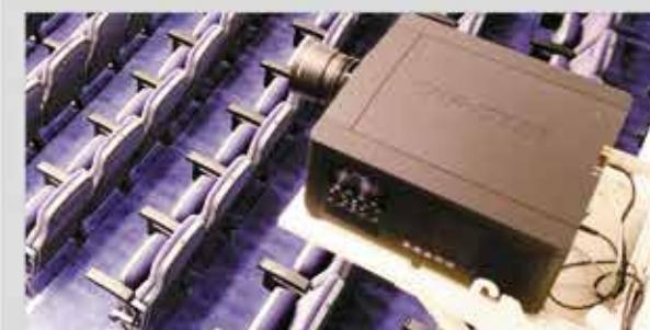
Проекция на большой экран осуществляется с помощью широкоформатного проектора Christie HD10K-M, оснащенного входным интерфейсом HD-SDI.
