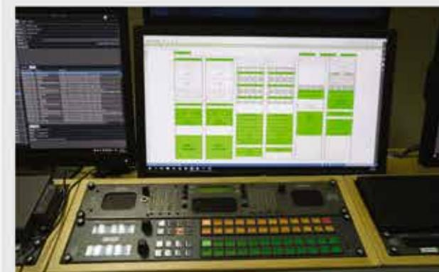
Мониторинг устройств (платформ, оборудования, операционных систем) осуществляется через систему Skyline DataMiner. Процесс построен по принципу одного окна, в котором обеспечивается доступ к любому компоненту системы и отображается текущий статус всех компонентов.
