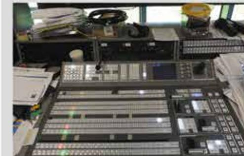
Видеомикшер Guramex GVM-2425 позволяет формировать две программы с резервированием ключевых элементов тракта.
