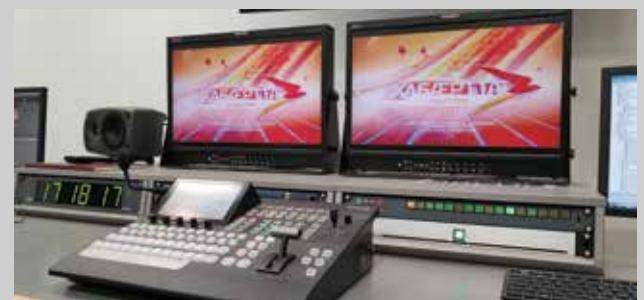
Основными рабочими инструментом режиссеров, являются видеомикшеры Panasonic: 32-входовый 2ME в основной аппаратной и компактный (12 входов) микшер в новостной АСБ.
