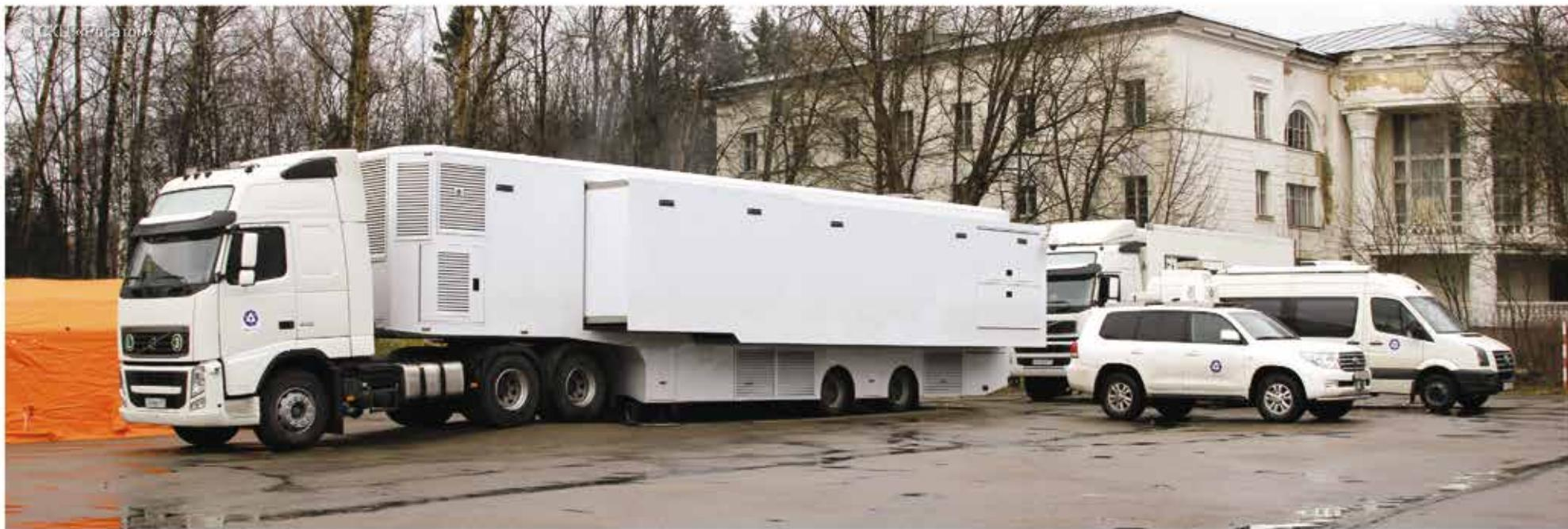
заданные параметры подвижного комплекса управления, такие как быстрое перемещение и оперативное развертывание, модульность и многофункциональность, длительная устойчивая работа в автономном режиме, возможность радиационного мониторинга и организации связи в любых условиях, как в движении, так и на стоянках, а также достаточно комфортные условия работы персонала.
