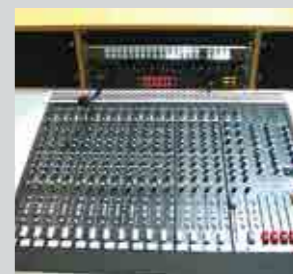
Для работы звукорежиссера установлен 16-канальный аудиомикшер Soundcraft K1.
