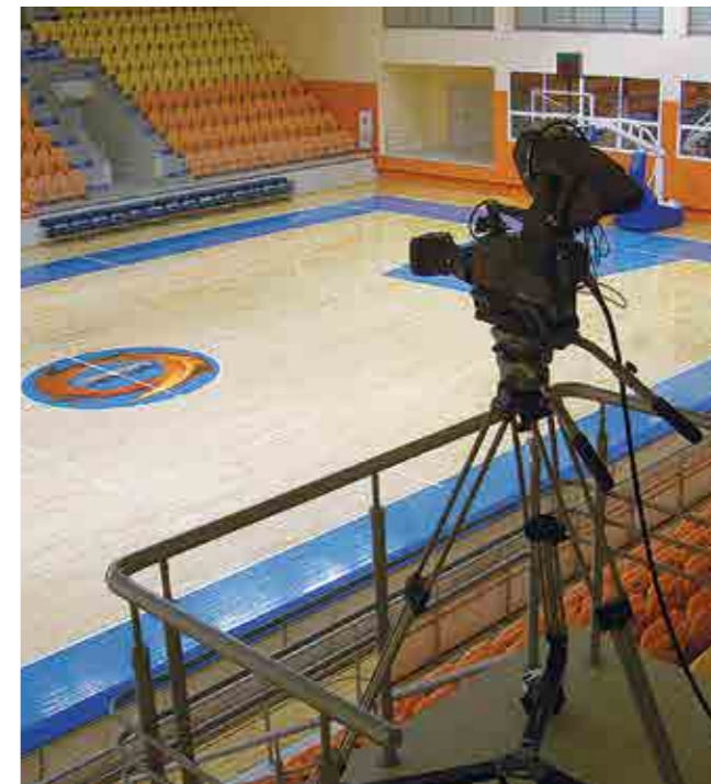
Камера общего плана Sony установлена на ДУ-головку Pele, закрепленную на центральной колонне зала.
