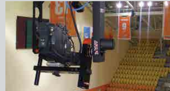
Камера общего плана Sony установлена на ДУ-головку Pele, закрепленную на центральной колонне зала.
