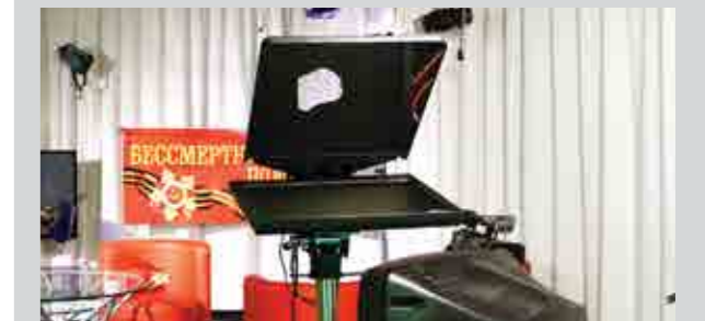
В блок входит телесуфлер с диагональю 48,3 см (19"). Большая диагональ позволит ведущему отходить дальше от камеры и более свободно перемещаться в пределах съемочной зоны.
