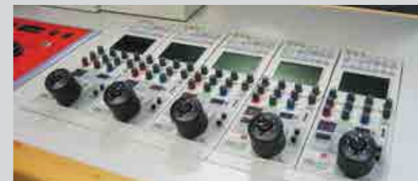
Настройка камер и управление ими осуществляются с панели ДУ RCP-D50.
